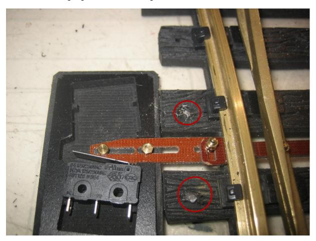
Außerdem sieht man hier, dass die überstehenden Enden der Senkkopfschrauben abgeflacht wurden (Kreise). Achtung, vorsichtig abtrennen, um zu viel Wärme zu vermeiden. Nun ist die Weiche "mechanisch" fertig.
