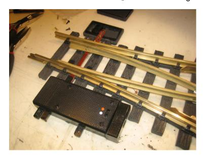
Zur Unterbringung der Kabel habe ich von unten entsprechende Schlitze gefräst.
