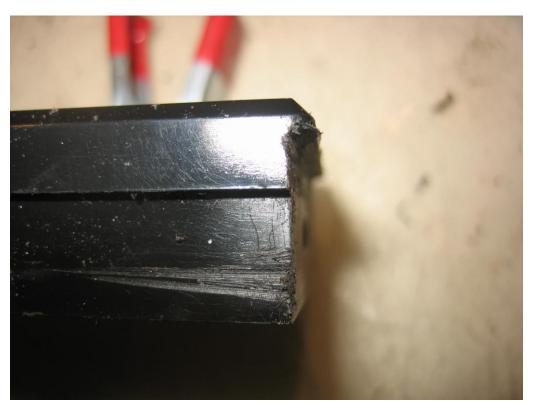
Zur Montage des Antriebs an der Weiche Müssen die "Füße" des Antriebs dünner werden (die gilt auch für das Umschaltergehäuse)
