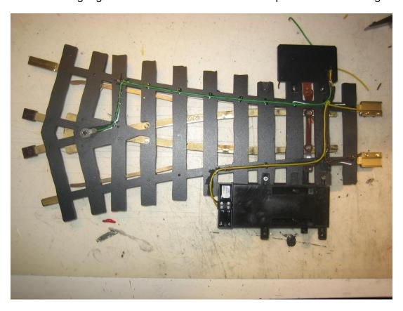
Die Stromzufuhr erfolgt über die Schieneverbinder rechts im Bild mit Lötlaschen.
