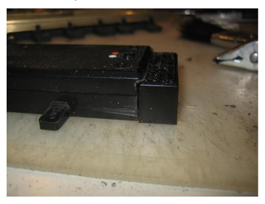
Um den Massoth Decoder bündig am LGB Gehäuse anzubringen, muß der Deckel des LGB Gehäuses ausgeklinkt werden.
