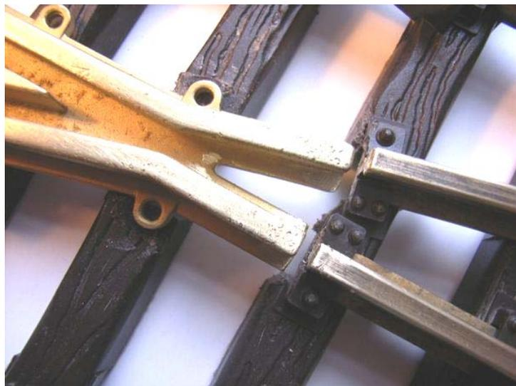
Eine Stromkontaktverbindung zum Herzstück lässt sich durch die Lötfahe herstellen, die Sie unter eine der Befestigungsschrauben anbringen. Mit dem Fahrstromumschalter (Best. Nr. 5914) erreichen Sie die richtige Polarität des neuen Herzstückes.
